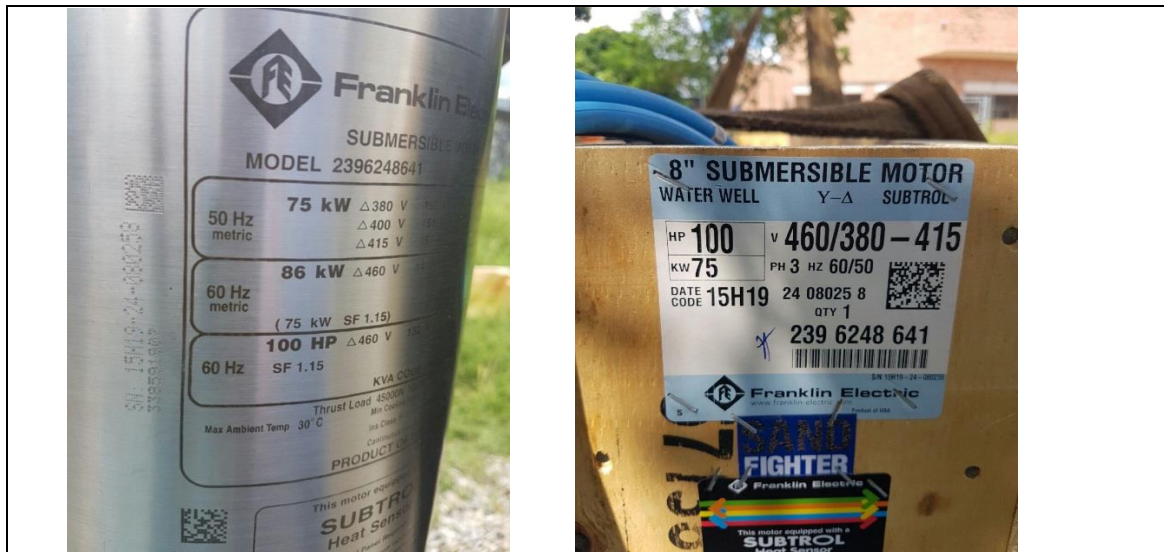
PLACA CON CARACTERISTICAS TECNICAS DE MOTOR SUMERGIBLE DE 100 HP/440-460V/60HZ
