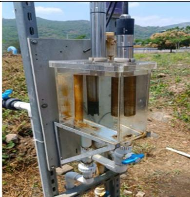
Se realiza mantenimiento correctivo y limpieza de los 8 sensores de turbiedad y cajas del mismo de la planta definitiva.
